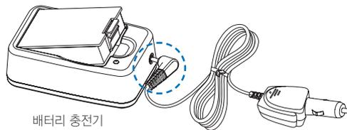
자동차 시가 잭 충전기를 프린터 또는 배터리 충전기에 연결하십시오.
